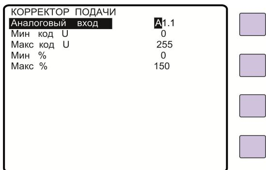
Для определения минимального и максимального значения кода напряжения на аналоговом входе необходимо подключить корректор и войти в **Режим отладки→Аналоговые входы**. Установить корректор в крайнее минимальное положение, запомнить значение на экране и записать его в параметр **Мин код U**. То же самое сделать для положения корректора в крайнем максимальном положении и записать значение в параметр **Макс код U**. Допускается ввод значений от 0 до 255.
