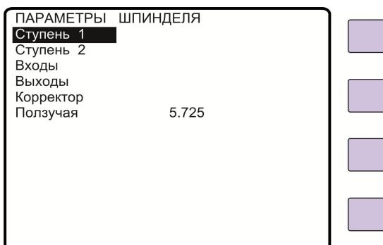
Направление вращения шпинделя для команд M3, M4 можно изменять знаками +/- в параметрах **Общие параметры→Конфигурация выходов→Шпиндель**. Для этого необходимо выбрать параметр **По часовой** для M3 или **Против часовой** для M4 и кнопкой переместить маркер в конец строки и нажать . При каждом нажатии будет меняться знак полярности аналогового выхода для команд M3 и M4.
