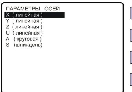
Для настройки параметров каждой оси необходимо кнопками и выбрать нужную ось и нажать кнопку . Будет выведен список параметров для данной оси. Для инкрементных и абсолютных датчиков меню будет разным.
