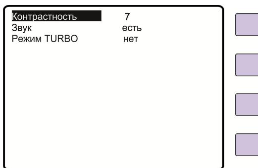
**Контрастность** - параметр предназначен для регулировки контрастности дисплея для лучшего отображения информации при различных углах обзора. Значения вводятся в диапазоне от 0 до 20.
