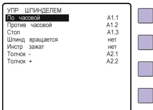
По часовой – если назначен вход, то при включенном внешнем пульте, сигнал на этом входе активирует выход управления шпинделем - **По часовой (M3)**.
